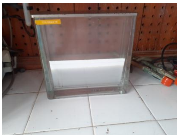
Plaque dans le cuve contenant solvant
