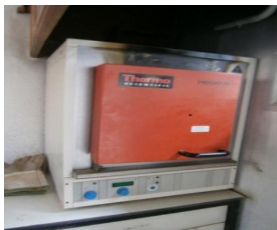
Photo 11. Incinération des échantillons au four
